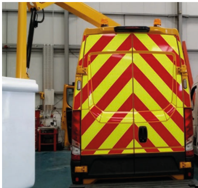
Immagine 1. Esempio di contrassegni ad alta visibilità per i veicoli, in questo caso motivi a zig-zag da apporre nella parte posteriore della macchina.
