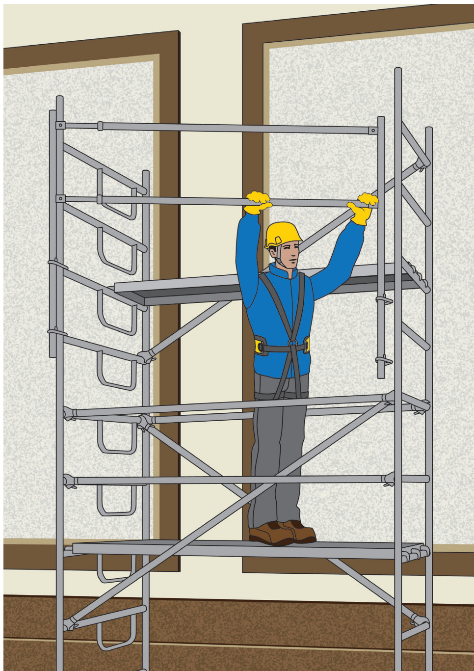
Figura 4 - Trabattello con montaggio dal basso
