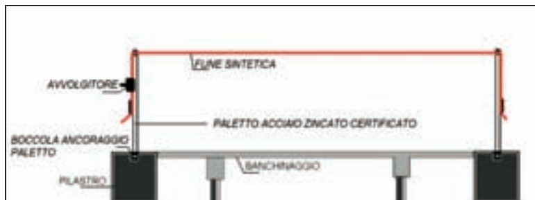
Figura – Componenti di una linea di ancoraggio
