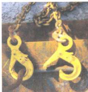
Ganci con dispositivo di chiusura dell'imbocco
