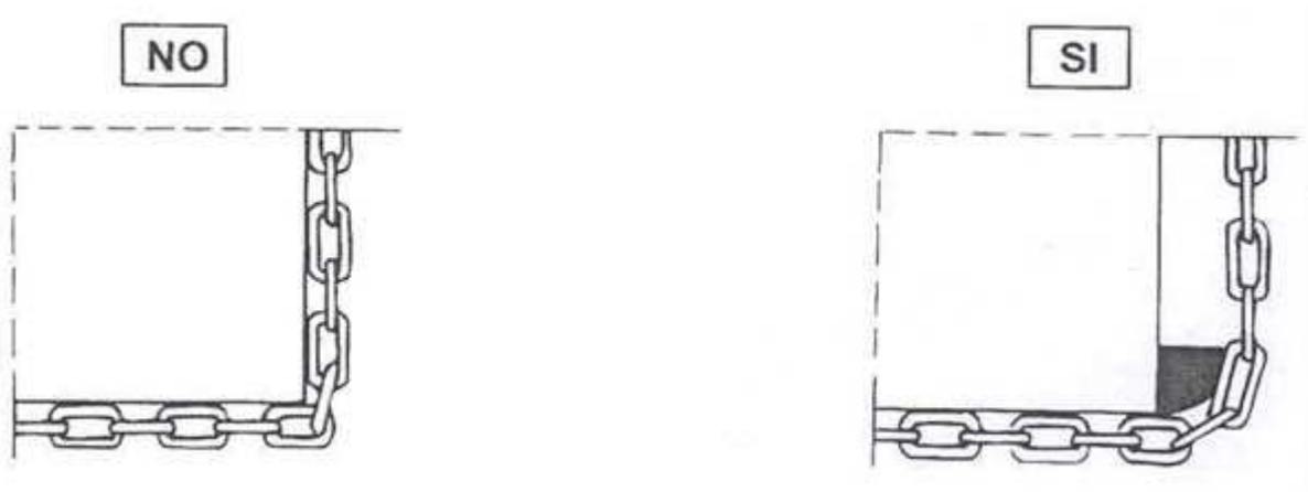
Figura 4 – Spessori per evitare danneggiamenti della fune o della catena
