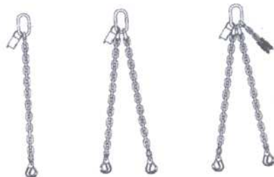
Pendenti a braccio singolo e a bracci multipli, con catene (o cavo d'acciaio) provviste di ganci alle estremità
