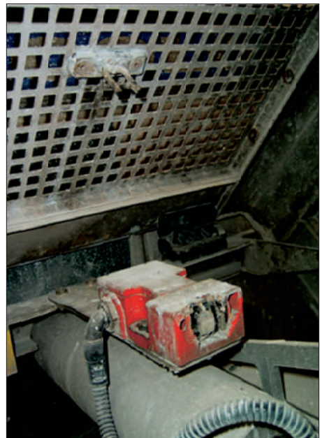
Figura 7: Interblocco esposto a condizioni ambientali severe
