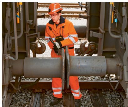
1, 2 Entrare nello spazio fra i veicoli solo quando questi sono fermi e i respingenti si toccano.
