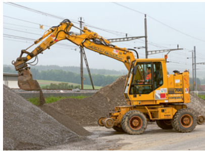
2 Macchina da cantiere in prossimità di una linea di contatto
