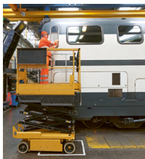
2 Sostituzione del filtro da una piattaforma di lavoro elevabile
