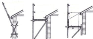
Parapetti per lavori di copertura
