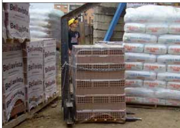
Confezione di laterizi resa solidale alle forche con catena
